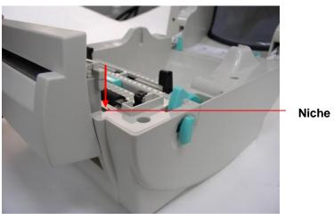
**Cutter module installation**
