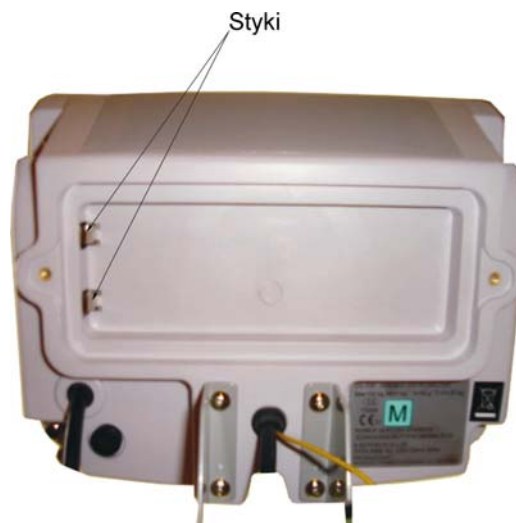
Tylna ściana konsoli bez zasobnika na baterie.
